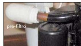
Conecte seu aerógrafo na saída do filtro-regulador e ligue o compressor. Caso ele comece a trepidar e desligar logo no início, deixe-o ligado até que a rotação do motor se estabilize. Isto é comum acontecer com motores novos ou recém-recondicionados, especialmente nos dias mais frios ou quando o motor fica muito tempo sem ser ligado.
